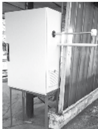
Міський автоматизований пост спостереження №5 здійснює виміри діоксиду азоту, діоксиду сірки, оксиду вуглецю, аміаку, пилу, озону та етану
